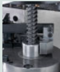
■ 照片2 photo2 MQL拉削加工 MQL Broaching 通过使环保型的植物油雾化，实现了利用微量供油进行加工
